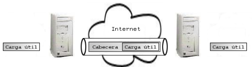
Figura 1.5: Concepto de tunelado. El paquete original es encapsulado dentro de un nuevo paquete en el terminador que lo envía a través de la VPN, y el otro terminador lo extrae, enviándolo tal cual a su destino.
